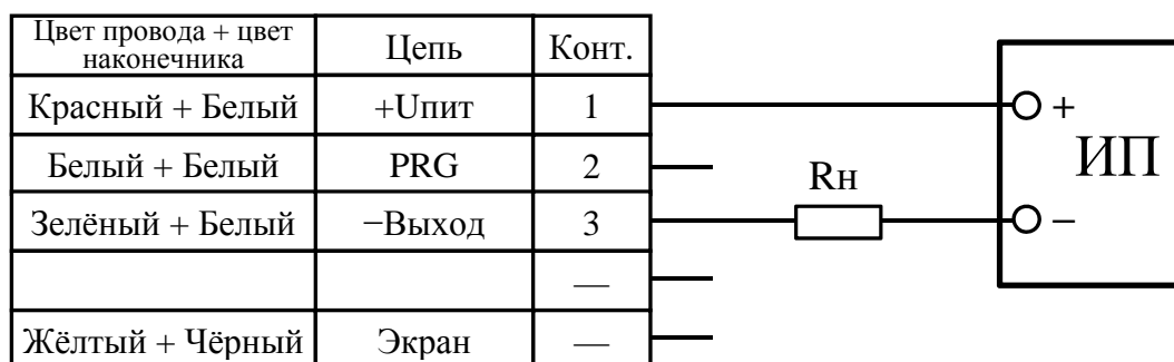
Рисунок В.3 — Соответствие цепей выводов разъёма преобразователей с кодами исполнений 14 и 15 по таблице А.10
