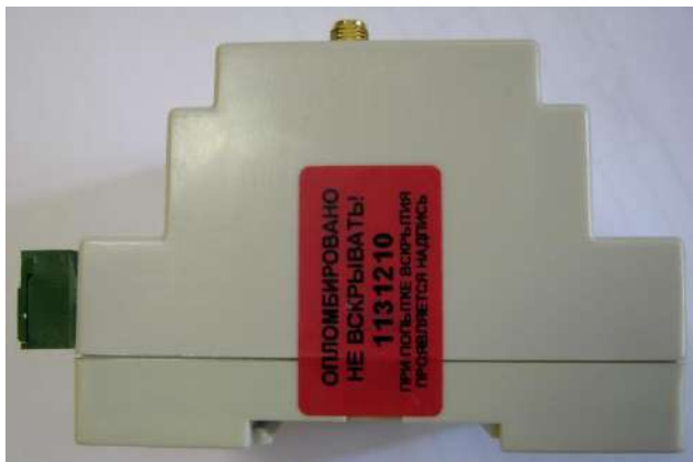
Рисунок 3.31 – Наклейка пломба на МПД-1
