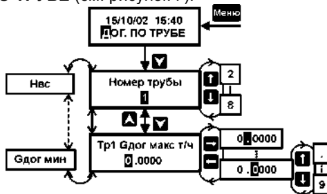
Рисунок 7 – Установка договорных параметров по трубопроводам
