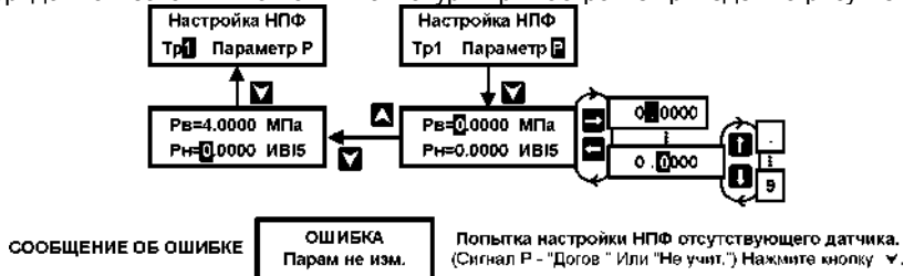
Рисунок 6.2 – Последовательность действий по настройке НФП датчиков давления
